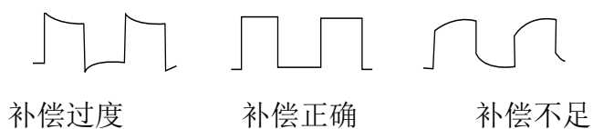
图 1-2 探头补偿校正
