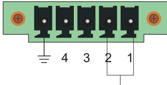
可远程操作短路或松开1, 2PIN, 控制电源的OUTPUT功能
