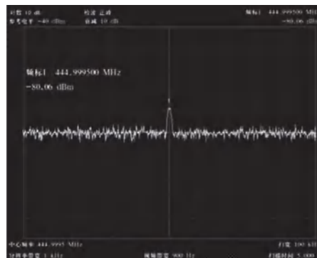
图3-14 减小分辨率带宽测量小信号
