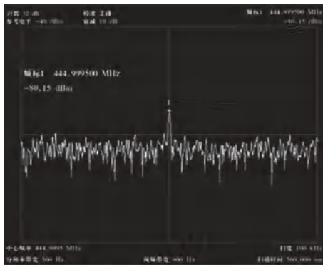
图3-15 增加扫描时间测量小信号
