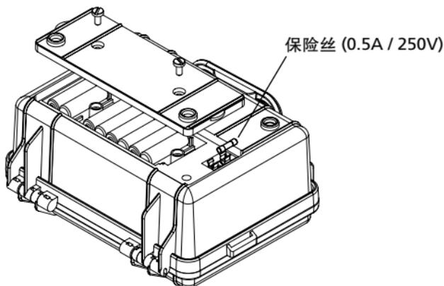
电源保险丝安装在测试仪背部。打开电池舱，更换上相同型号(0.5 A, >24V, 慢熔)的保险丝。
