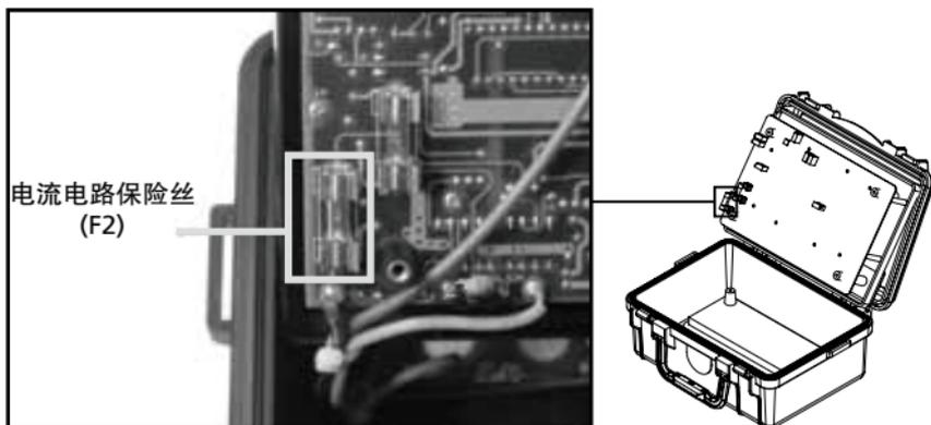
电流端子上具有保险丝保护。该保险丝安装在印刷电路板下方。如需操作该保险丝，需要拧松固定前面板的4个安装螺钉。其中两个螺钉位于支脚下方，另外两个位于电池舱内部。
