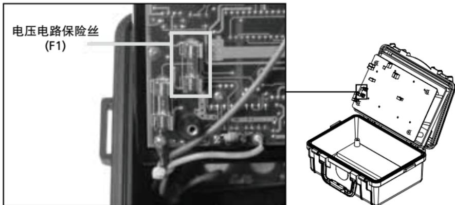
电压端子上具有保险丝保护。该保险丝安装在印刷电路板下方。如需操作该保险丝，需要拧松固定前面板的4个安装螺钉。其中两个螺钉位于支脚下方，另外两个位于电池舱内部。
