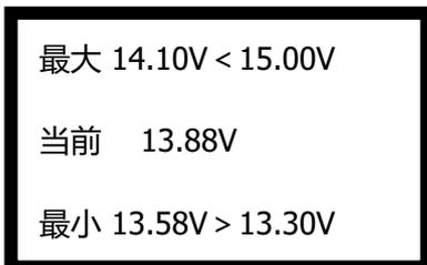
充电系统最高输出图中分别显示当前的测试电压 13.88V，标准最高电压 15.00V（对于 6V 系统，标准最高电压为 7.50V；对于 24V 系统，标准最高电压为 30.00V），以及测得最高电压 14.10V。
