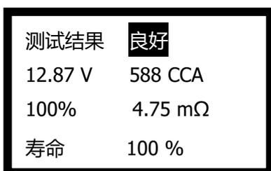
8) 此时按中间按键将进入询问是否需要打印测试报告（见 5.6 节），按<ESC>按键将返回步骤（4）选择电瓶型式。
