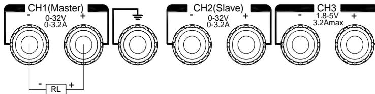
并联模式下，输出电流为单通道的两倍，CH1 与 CH2 在电源内部被并联连接，CH1 为控制通道。
