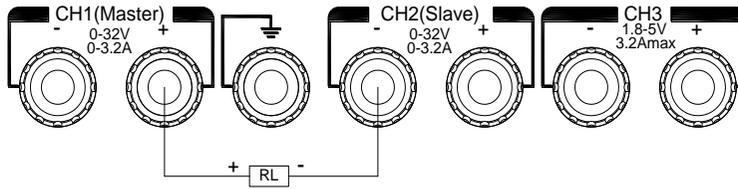
串联模式下，输出电压为单通道的两倍，CH1 与 CH2 在电源内部被串联连接，CH1 为控制通道。
