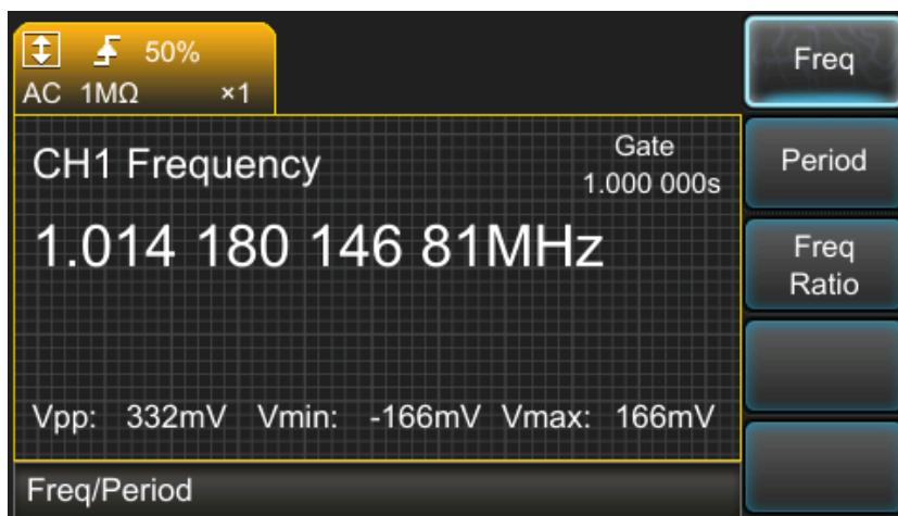
仪器开机初始化就会进入通道 1 的频率测量状态。在其它情况下，可以通过面板的【Freq/Period】按键直接进入此功能，默认为通道 1 的频率测量。显示界面如上图
