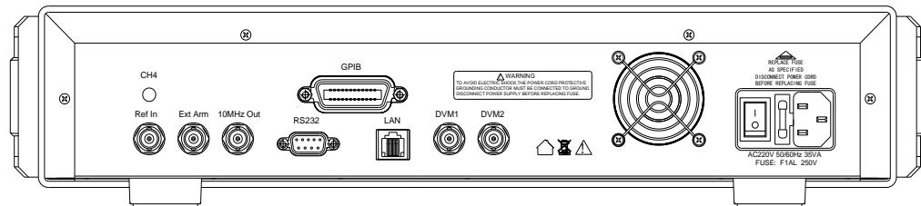
**Ref In** 外频标输入，可选 5MHz 或 10MHz，仪器内部自动切换
