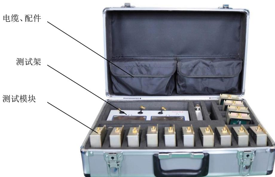
SD3200MW 微波电路实验模块箱内包括：
