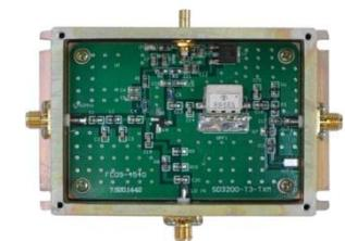
混频器输出频率  $f_0$ : 70MHz
