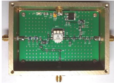
图 (5.10) 上变频器内部示图
