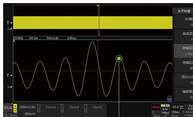
1.4 M 存储深度，捕获 700ms 波形，采样率下降至 2 M，波形已经完全失真
