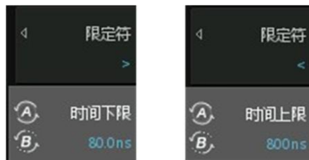
旋转旋钮A微调时间下限或上限，旋转旋钮B可粗调时间下限或上限
