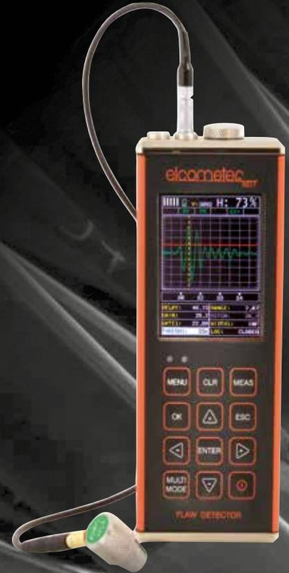
手持式FD700探伤仪系列结合最先进的探伤检测和先进的材料厚度能力。
