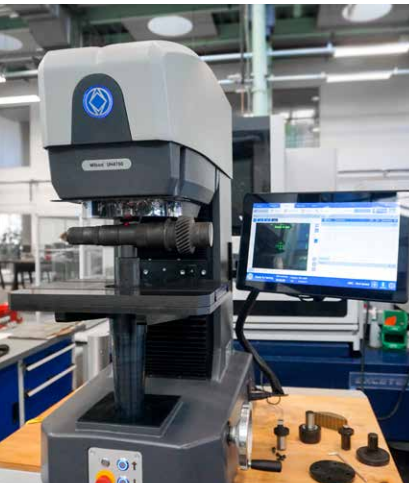
UH4000 可在大型测试台上加装小型试台，以完成对小型试样的测试。
