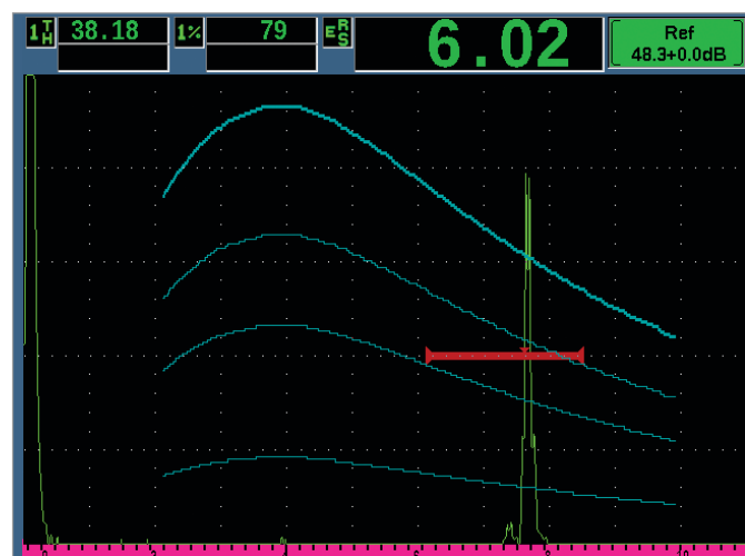
EPOCH 650探伤仪的DGS/AVG功能 - 全屏模式
