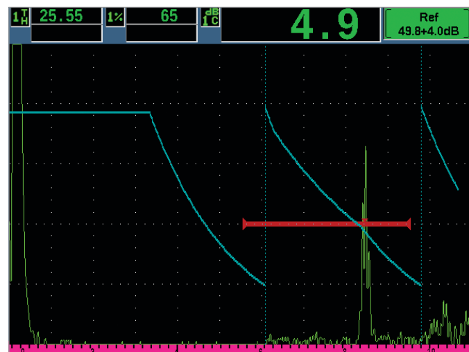
EPOCH 650探伤仪的动态DAC/TCG功能
