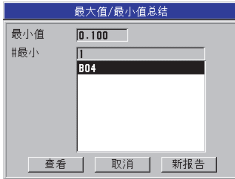
图 6-45 最大值 / 最小值总结报告的结果屏幕
