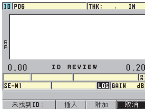
图 6-38 当数据库中不存在被编辑的 ID 码时所出现的提示信息
