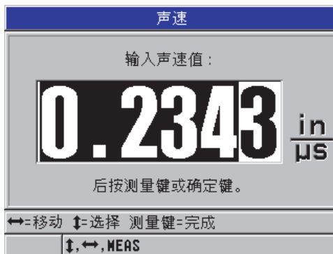
图 5-9 输入一个已知材料声速
