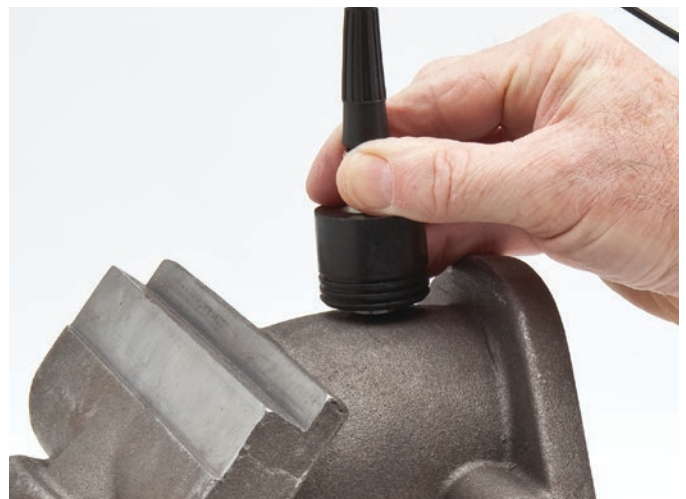
高穿透软件选项可以对很多铸造金属部件及声波衰减性较强的材料进行测量
