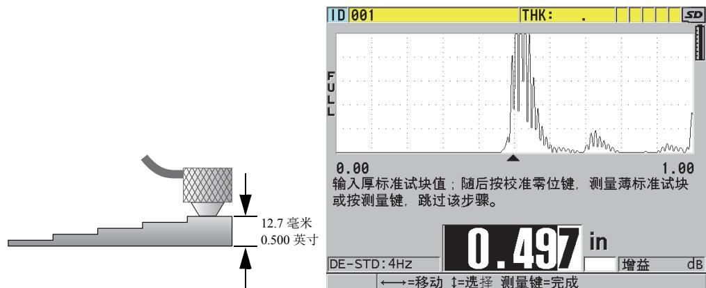
图 5-4 在5阶梯试块上进行材料声速校准
