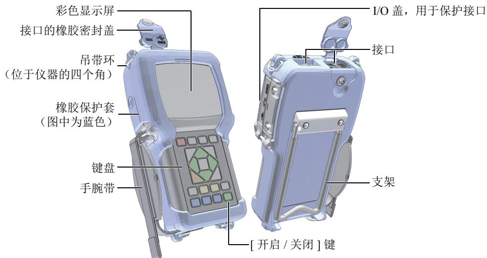
图 1-2 38DL PLUS 仪器的硬件组成部分
