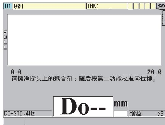
图 5-2 使用标准 D79X 双晶探头的初始屏幕
