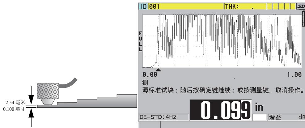
图 5-5 在 5 阶梯试块上进行零位校准
