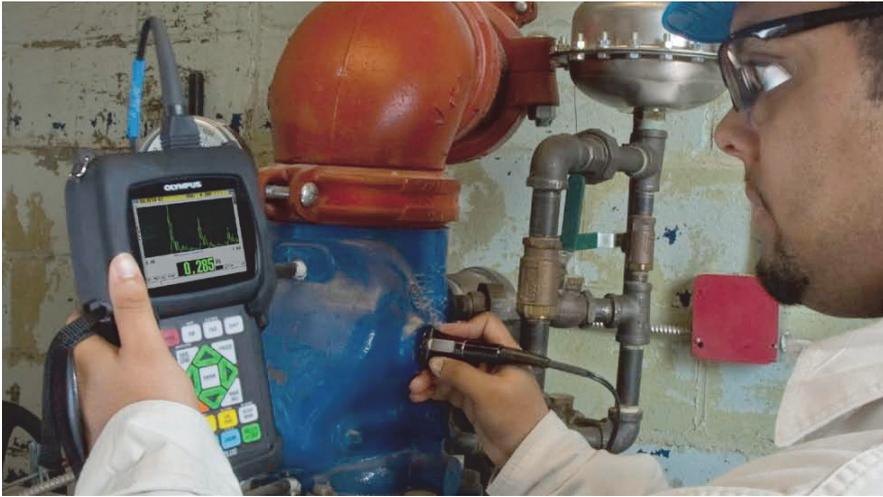
图 1-1 使用 38DL PLUS 仪器测量材料的厚度
