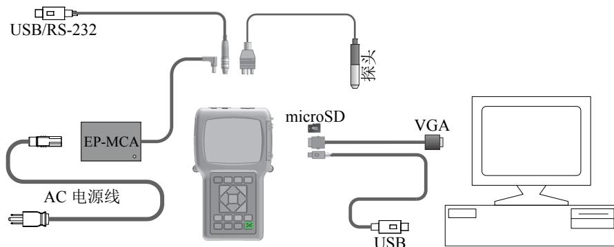
图 1-3 38DL PLUS 仪器的连接情况
