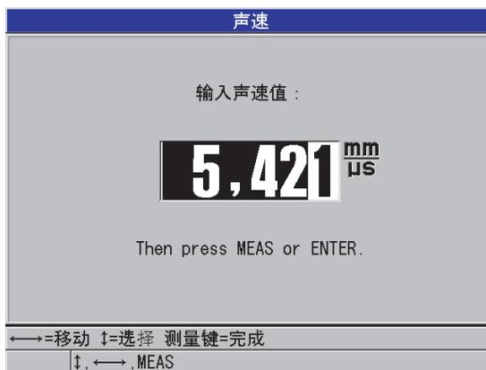
图 5-7 输入一个已知材料声速
