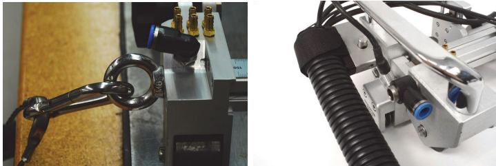
图 3-1 将脐带电缆连接到连接环上
