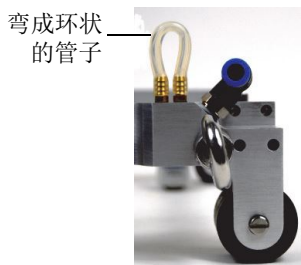
图 3-3 使用环状管子将未使用的歧管出水口连接起来
