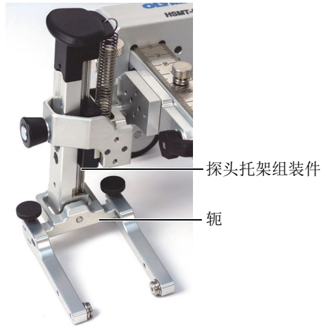
图 2-3 轭垂直于探头托架
