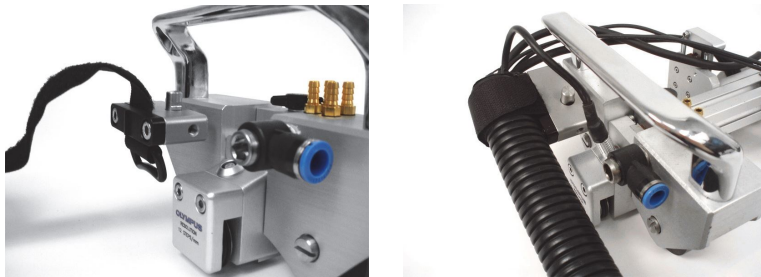
图 2-9 松开带子（左图）；拉紧带子（右图）
