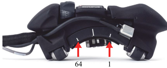
图 4-4 楔块上的探头晶片标记
