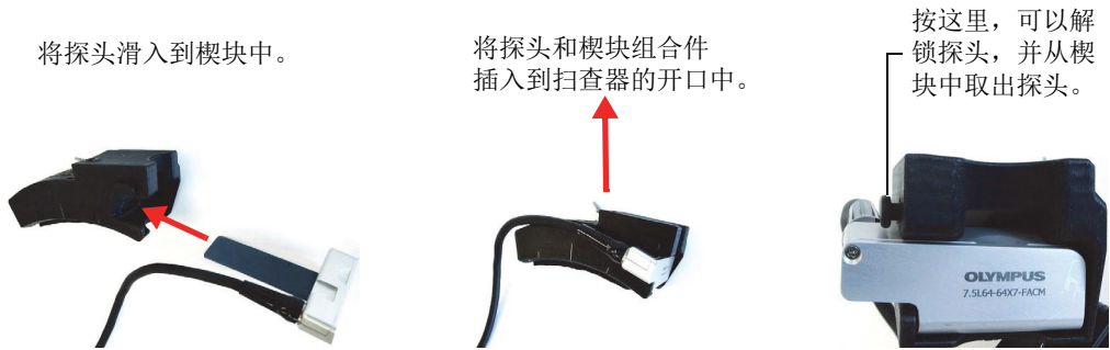
图 2-3 安装探头和楔块
