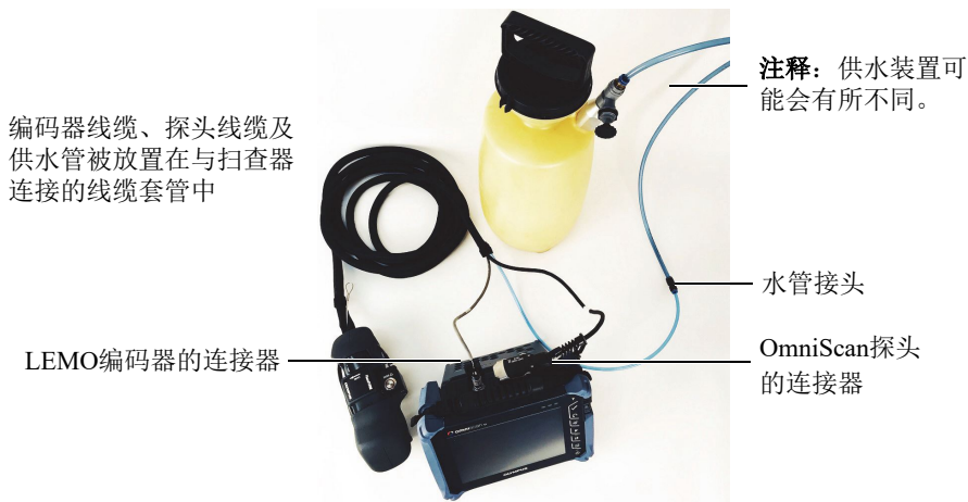
图 2-4 扫查器相关线缆的连接情况
