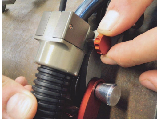
图 A-14 将脐带线缆连接到 ChainSCANNER 扫查器
