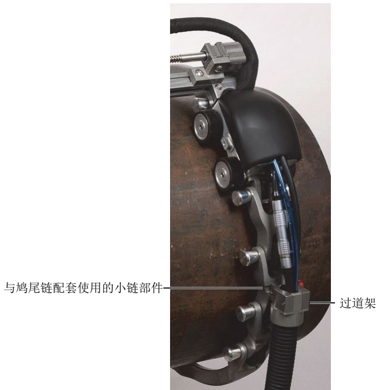
图 2-10 脐带线缆的过道架
