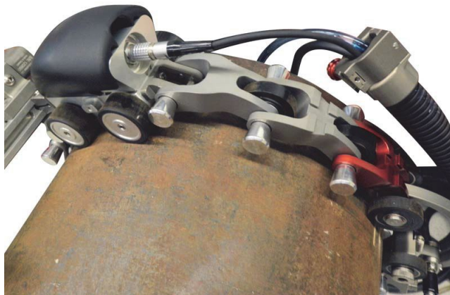
图 A-13 将脐带线缆连接到 ChainSCANNER 扫查器的主模块
