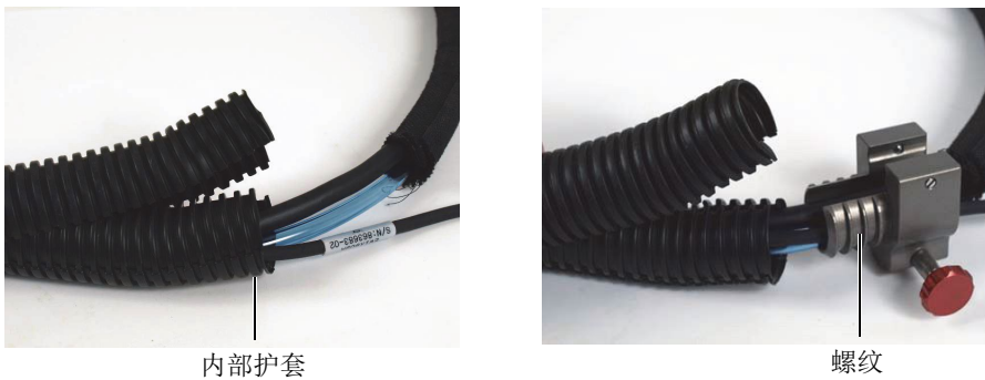
图 A-11 将过道架的带螺纹部分插入到内侧的线缆护套上
