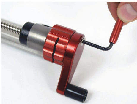
图 A-5 将手柄安装到大旋钮组件上
