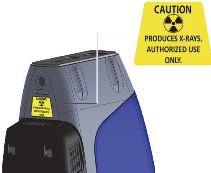
图 i-3 辐射警告标签位于Vanta分析仪探头的下方
