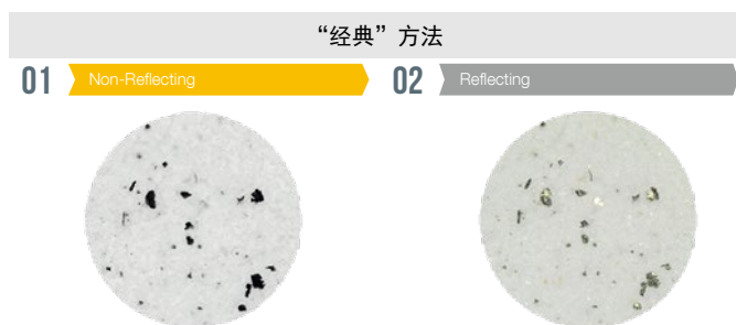
创新型照明系统可在一次扫描中区分反光颗粒（金属）和非反光颗粒（非金属）。
