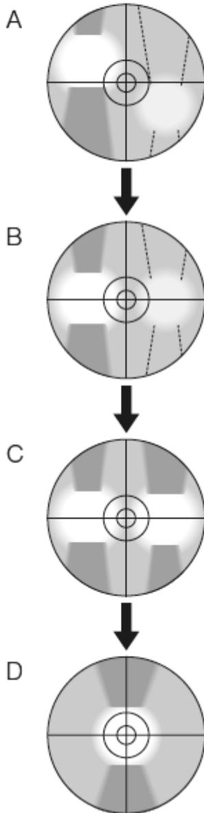
**9** 旋拧聚光镜调焦旋钮，将电弧图像投射到 U-CST 上。
