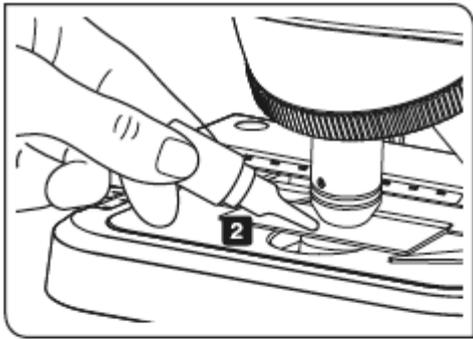
在油浸物镜前端使用指定的浸油。否则就无法对焦观察图像。
