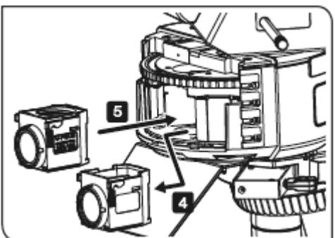
**4** 握住要更换的荧光分光镜组件的侧面，向前拉，取下镜组。
