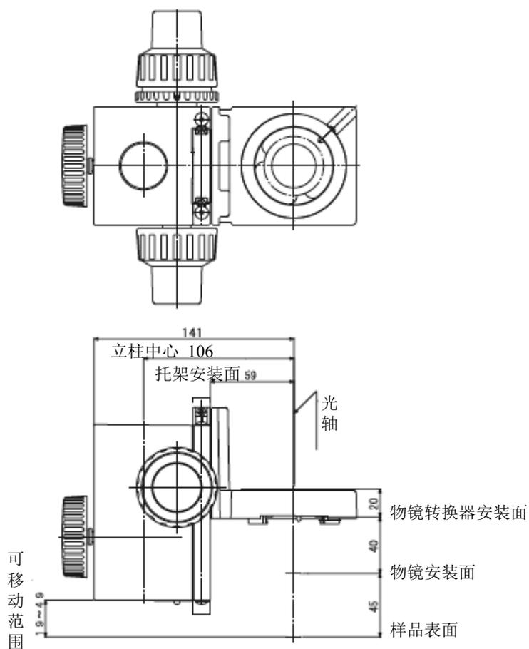
带照明器安装托架 / 用于 BXFM 的辅助弹簧
