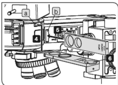
图上显示了 BX3M-URAS-S 的插入部件。BX3M-RLA-S 或 BX3M-KMA-S 也提供了相同的插入部件。
