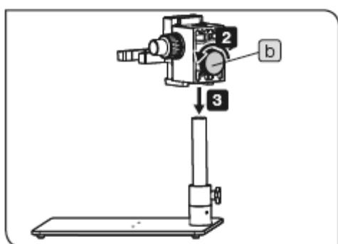
2 旋转 BTFM 机架 (BTFM-F) 的旋钮 **b**，拧松机架。
