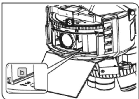
**3** 旋转塔台，直到要更换的荧光分光镜组件的孔位编号 **b** 处于前端，听见咔嚓声时停止。
