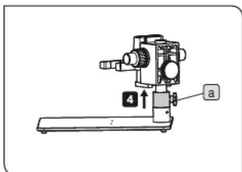
4 抬起防坠环，直到其接触 BTFM 机架的底部，然后拧紧旋钮 **a**。
