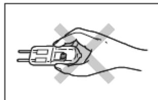
**注意** 小心不要用手直接触摸灯泡，避免灯泡上留下手指印或污渍。否则灯泡可能因污渍导致的玻璃变形而爆炸。如果灯泡上留有手指印或污渍，请用蘸有无水酒精的洁净纸轻轻擦拭。
