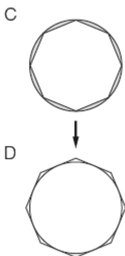
**5** 调节视场光阑拨杆（视场光阑拉杆），打开视场光阑，直到视场光阑图像内接于视场。（图 C）。如果视场光阑图像没有对中，请再次对中。
