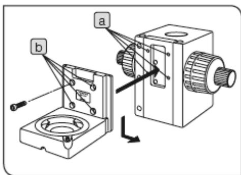
本图显示了安装用于 BXM-S 的照明器托架（BXM-ILHS）的步骤。安装其它照明器托架时，可以使用相同的步骤。
