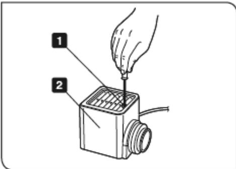
**1** 使用六角螺丝刀拧松灯箱顶部的固定螺丝。
