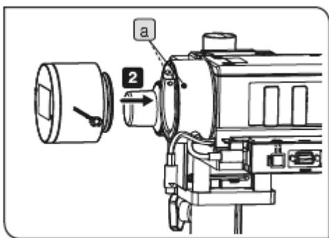
此图显示了安装反射 LED 灯箱(BX3M-LEDR) 的步骤。安装其它光源时，可以使用相同的步骤。
