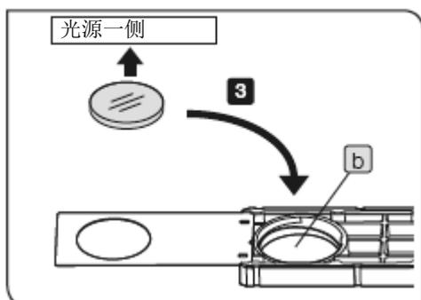
**注意** 如果指定了所用滤光片的朝向，插入滤光片时需要使光源一侧滤光片表面朝上。
