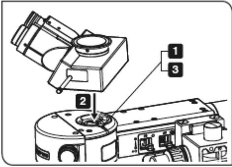
此图显示了安装三目镜观察筒（U-TR30-2）的步骤。安装其它观察筒时，可以使用相同的步骤。
