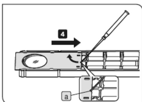
**4** 将精密螺丝刀插入凹槽 **a**，抬起并滑动盖板，使其回到原来位置。同时，将滑动盖板按进卡扣（6个位置）**c**，直到听见“啪嗒”声。
