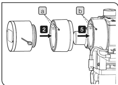
此图显示了安装反射 LED 灯箱(BX3M-LEDR) 的步骤。安装汞灯灯箱时，可以使用相同的步骤。
