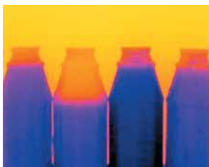
检测无色透明的液面。
