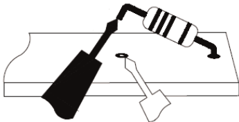
图 5.1 断开组件连接
