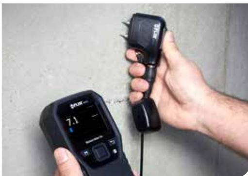
外部探针用于测量电阻材料的湿度
