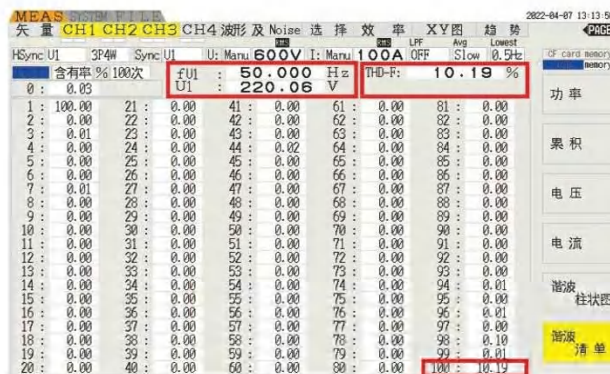
100次谐波10%幅值@220V/50Hz输出精度
