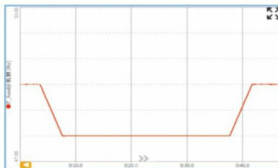
输出频率50Hz降低至48Hz，保持30s后恢复
