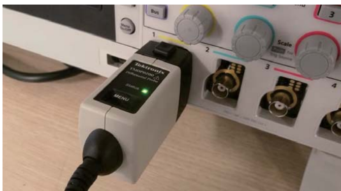
TekVPI 探头把标度设置、量程和状态传递给 TBS2000X。
