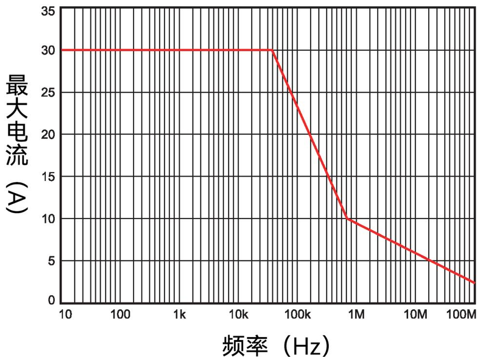
**警告:** 测量高频电流时, 注意不要超过最大电流 VS 频率曲线所示电流值, 超过该曲线所示最大连续电流使用会导致探头烧毁。
