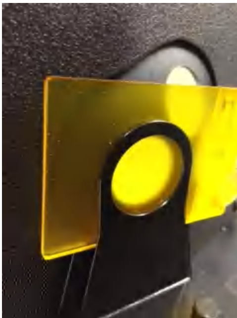
透射支架 - 色样在积分球侧（全测量）用于 25 毫米、17 毫米、10 毫米和 6 毫米测量
