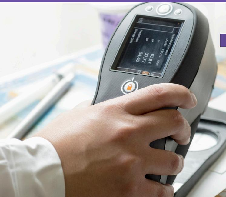
“Color iMatch 使工作更轻松。我可以带着 Ci64UV 在工厂各处走动，测量不同的东西，下载数据到 iMatch，评估结果，并在必要时打印出报告。UV 版本推荐用于含有荧光增白剂的一些人造纤维。”
