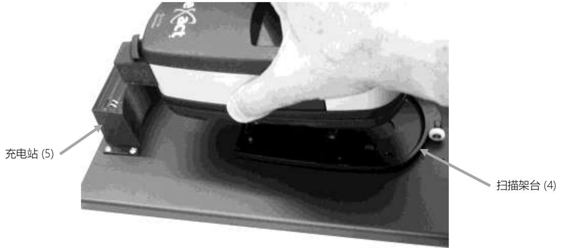
7. 逆时针旋转锁定臂 (6) 直至其停止, 从而将 eXact 固定到扫描架台。这样可以在扫描过程中保持仪器在适当位置。
