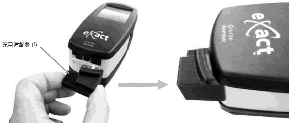
注意：如果未使用蓝牙功能，请将 eXact 仪器的 USB 路由到充电适配器顶部的信道。这有助于防止电缆在运行期间干扰充电站和轨道。此 USB 电缆与先前安装的 eXact 自动扫描系统 USB 电缆是分开的。
