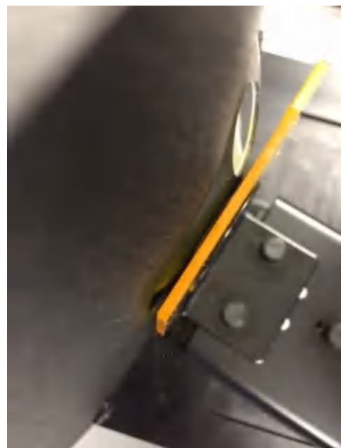
透射支架 - 色样在积分球侧（全测量）用于 25 毫米、17 毫米、10 毫米和 6 毫米测量
