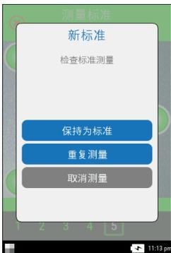
11. 轻触了“保持为标准”后，仪器进入目标模式。将仪器定位在样本区域，以“仪器定位”中所述方式进行测量。
