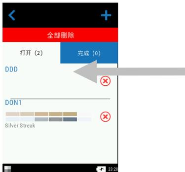
4. 显示所选工作的测量检查点信息。此例中，将要测量汽车的引擎盖和保险杠。轻触检查点列表中的引擎盖将仪器置于目标模式。
