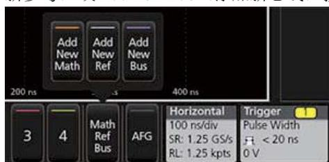
2. 仪器会将波形添加到波形视图，波形标记添加到设置栏，并打开配置菜单。本示例说明如何添加数学波形。
