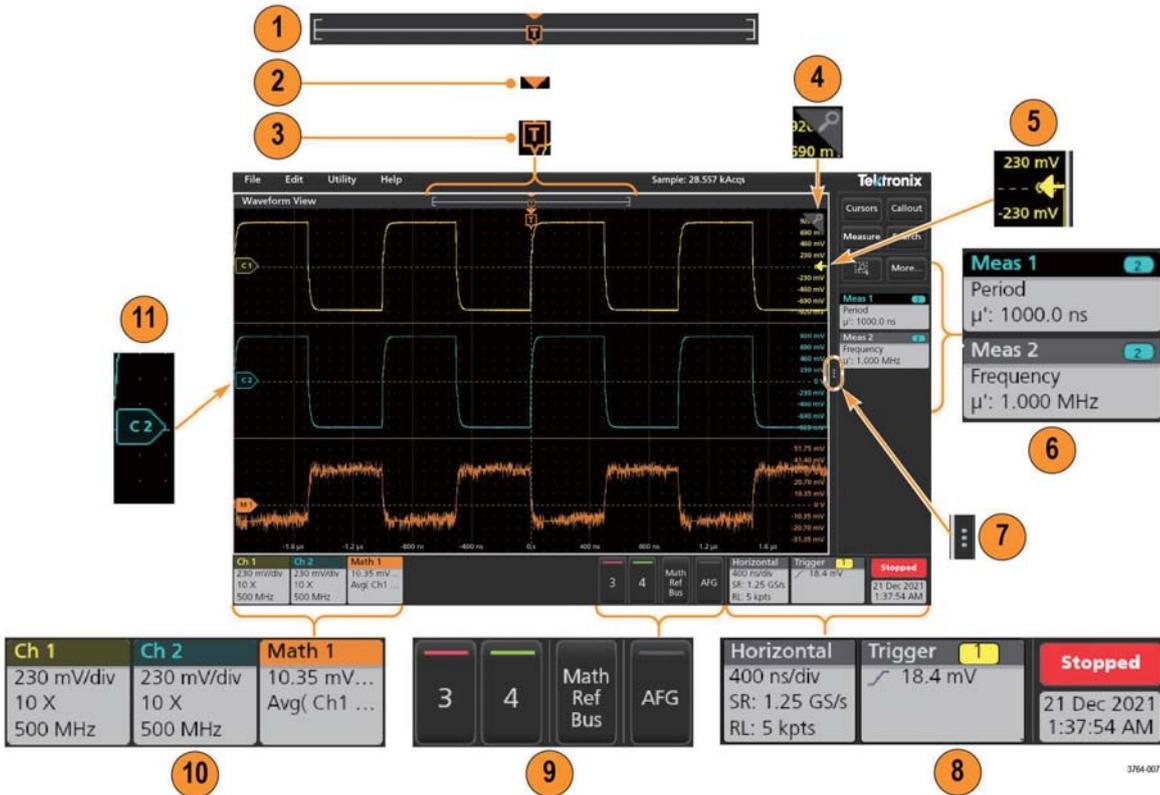
1. “波形记录视图”为图形化高级视图，包括整个波形记录长度、屏幕上的记录数量（以括号显示）、包括触发事件在内的主要时间事件位置以及当前波形光标位置。
