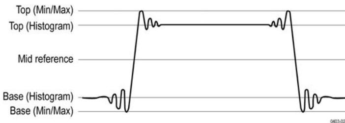
**直方图平均值**利用直方图分析方法，通过使用波形中点上方和下方的所有值计算平均值。“最高值”设置为高平均值，“最低值”设置为低平均值。此设置最适合检查眼图和光信号。
