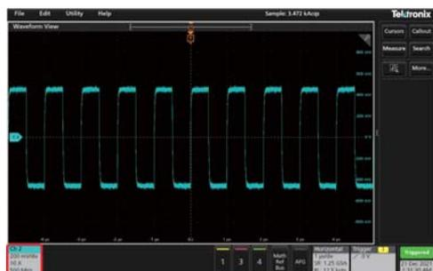
3. 继续点击 Inactive Channel（未激活通道）按钮添加更多通道（模拟）。通道的显示顺序为：编号最小的通道在上，编号最大的通道在下，而无论其添加顺序如何（在“堆叠”模式下）。
