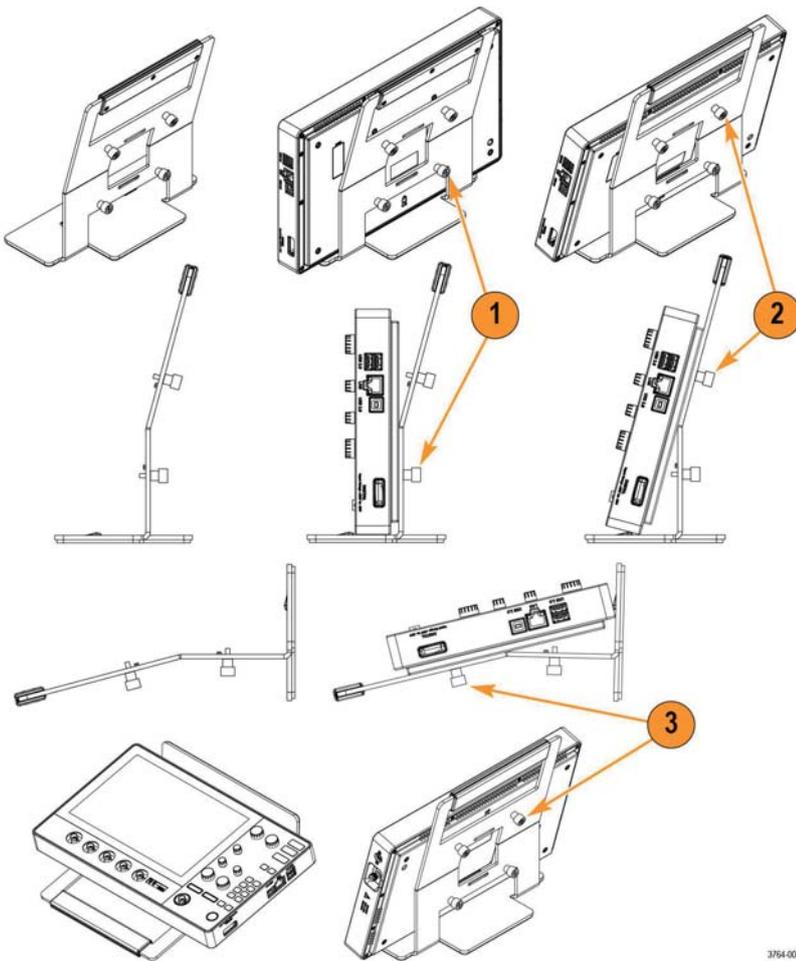
1. 用手将支架底部两颗螺钉拧紧至底部的两个 VESA 螺钉固定座。
