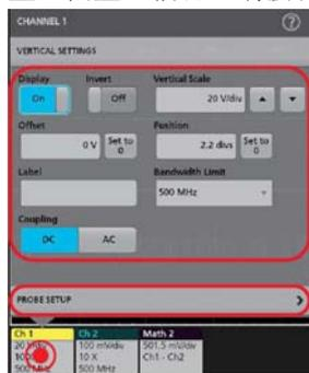
2. 点击 **Probe Setup**（探头设置）面板确认探头设置并运行所支持的探头的配置或补偿。
