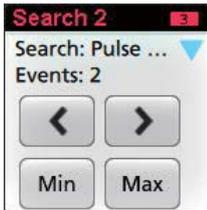
某些搜索还提供 **Min**（最小值）和 **Max**（最大值）导航按钮，可打开缩放模式并将波形在显示中按该搜索事件在当前采集中的最小值或最大值居中。
