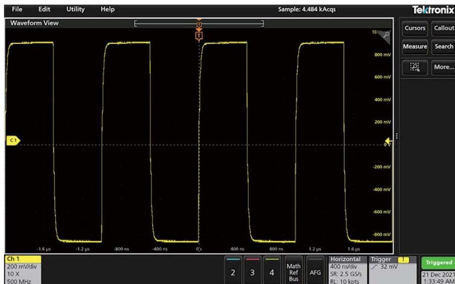
在使用覆盖显示模式时，仪器调整触发源通道的水平和触发设置以便显示此通道的已触发波形。“覆盖显示”模式下所有活动通道的垂直标度和位置调整均由用户首选项菜单的自动设置面板中的在覆盖显示模式中自动设置优化选项控制。如果选项为可视性，自动设置将垂直标定和定位所有活动通道波形使它们在屏幕上均匀隔开。如果选项为分辨率，自动设置将垂直标定和定位所有活动通道波形使它们均尽量多使用 ADC 的范围。
