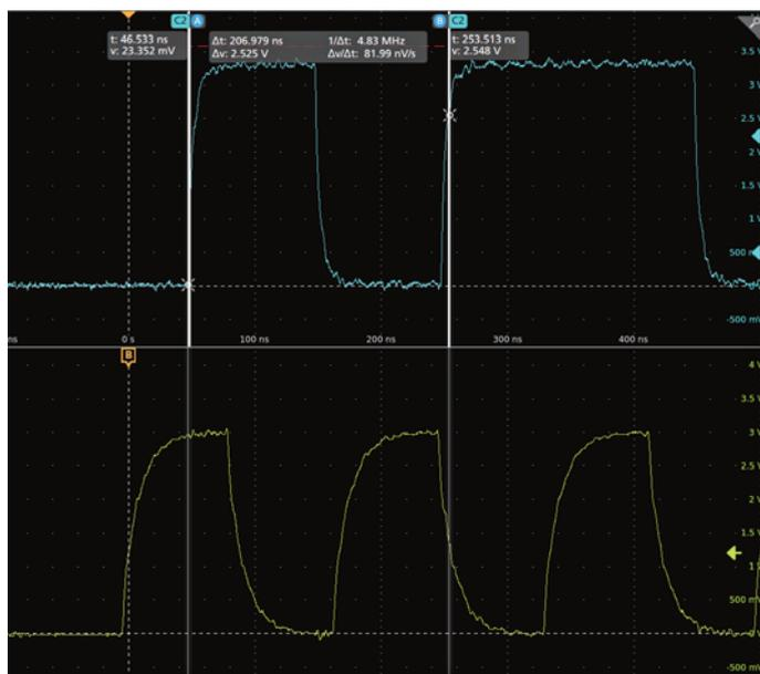
3. 使用多功能旋钮 **A** 和 **B** 来移动光标，或者触摸和拖动光标。光标读数可显示光标位置以及测量差异。
