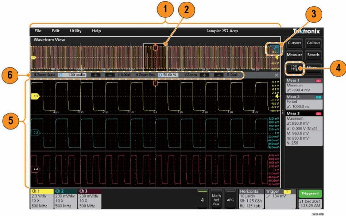
1. **缩放概述**显示整个波形记录。所有波形在缩放概述区域中以叠加模式显示。
