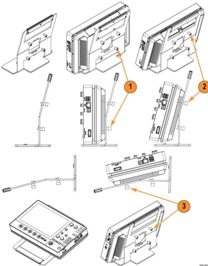
1. 用手将支架底部两颗螺钉拧紧至底部的两个 VESA 螺钉固定座。仪器现在竖直固定在支架上。
