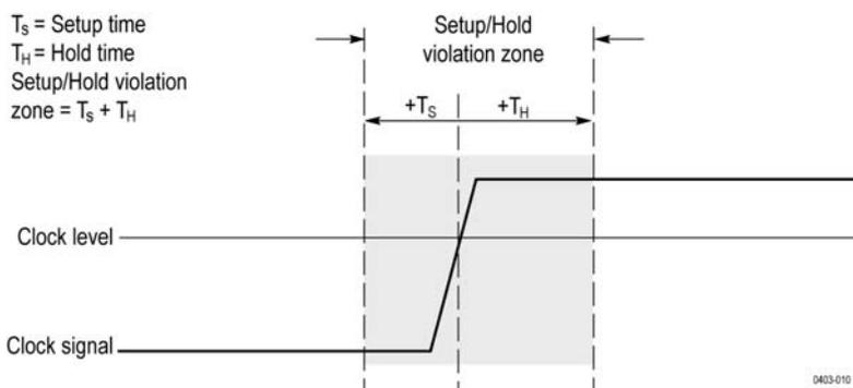
建立时间/保持时间触发使用建立时间/保持时间违规区来检测在过于接近定时时间时数据不稳定的时间。每次触发释抑结束后，仪器将监测数据和时钟源。发生时钟边沿时，仪器将检查它针对建立时间/保持时间违规区内发生的跳变所处理的数据流（来自数据源）。如果发生任一情况，仪器将使用位于时钟边沿的触发点触发。
