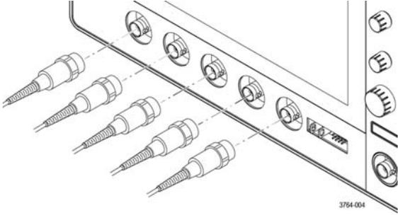
将 BNC 无源探头或电缆推入通道 BNC 卡口连接器中将其连接，然后，顺时针旋转锁定装置直至锁紧。
