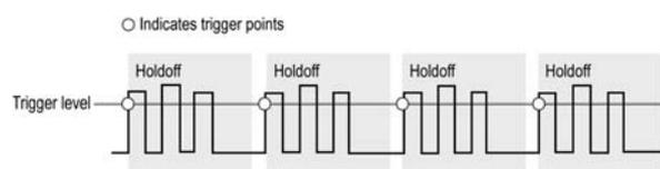
“触发释抑”设置范围为 0 s（最低可用释抑）至 10 s（最高可用释抑）。对于如何设置触发释抑的更多信息，请参阅[设置触发释抑 on page 85](#)。
