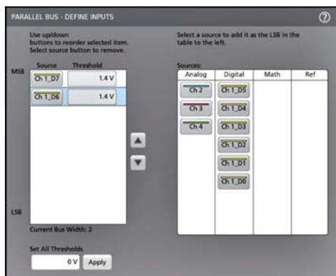
当您在配置菜单上进行更改时，总线波形会更新。点击波形手柄旁边的 + 符号，以打开和关闭与总线波形关联的信号显示。
