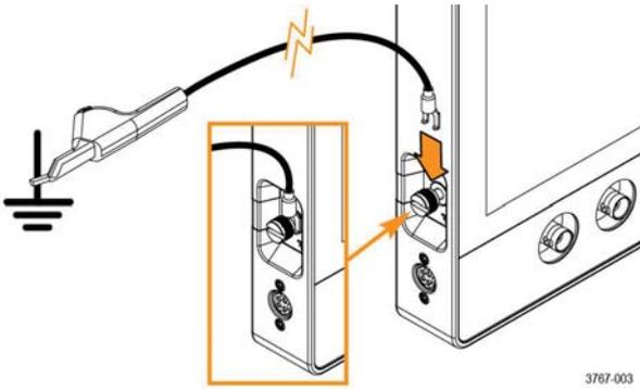
如果选择不连接接地线，则将示波器连接危险电压时将缺少防电击保护。如果没有在探头端部、BNC 连接器中心或公用导线上连接大于  $30 V_{RMS}$  ( $42 V_{pk}$ ) 的信号，则仍可以使用示波器。确保所有的探头公共导线连接到相同的电压上。
