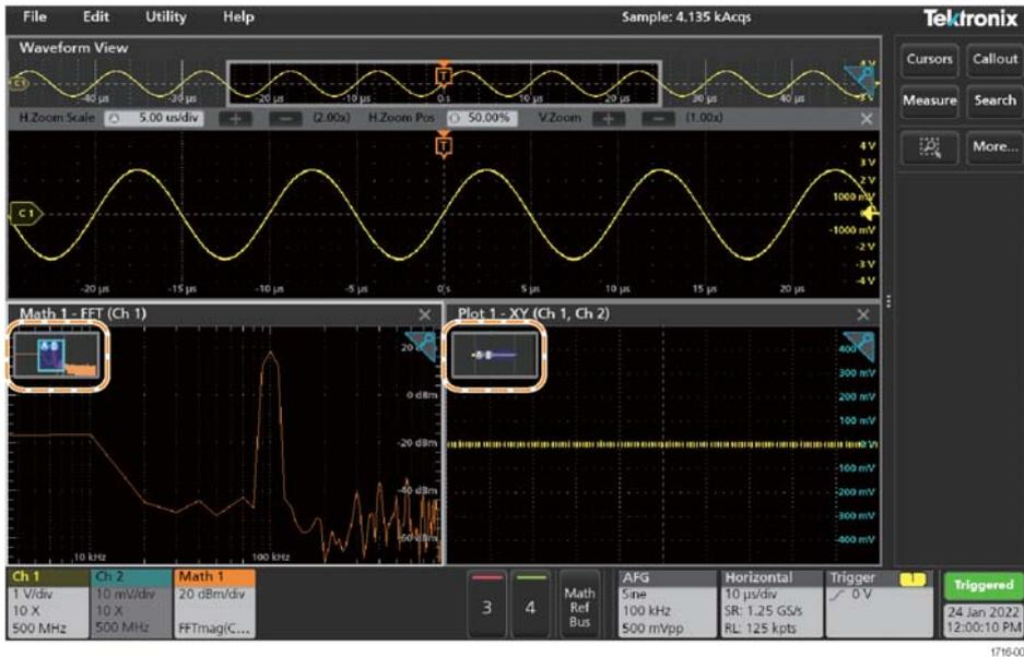
如果在数学 FFT 或 XY 绘图视图中同时打开了“光标”和“缩放”，则使用 **缩放框**和 **光标**按钮可更改多功能旋钮的功能。点击**缩放框**可将旋钮分配为调节缩放，或点击**光标**按钮将旋钮分配为调节光标。
