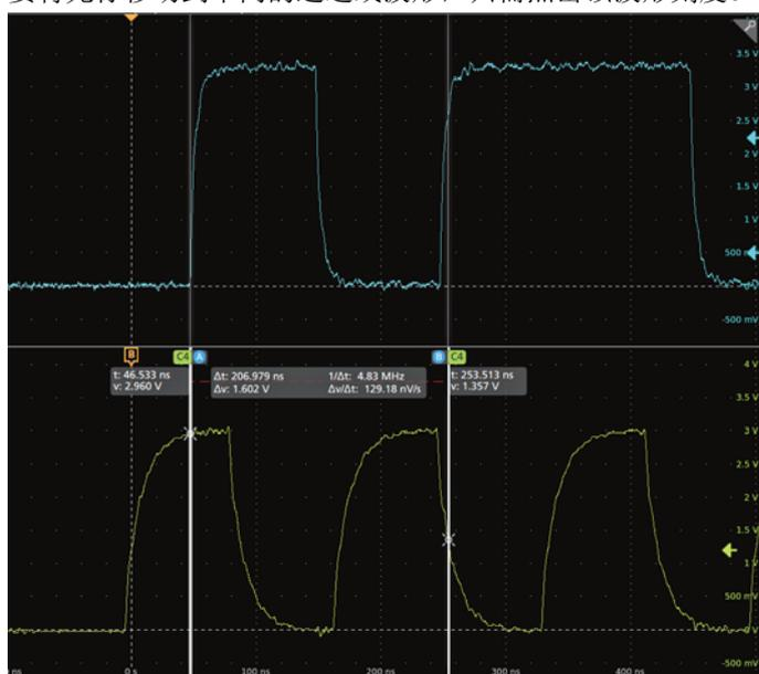
5. 要进一步配置光标，请双击光标线或光标读数以打开 **Cursors**（光标）配置菜单。例如，点击“光标”类型选择要显示的光标，如“波形”、V Bars（垂直条）、H Bars（水平条）或者 V&H Bars（垂直和水平条）。
