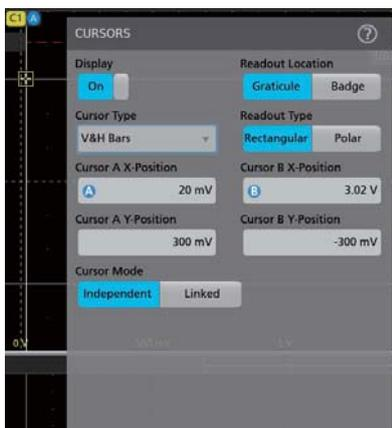
6. 要拆分两个波形之间的光标，请单击源字段并选择拆分来选择每个光标的源。光标将被移动至特定波形。
