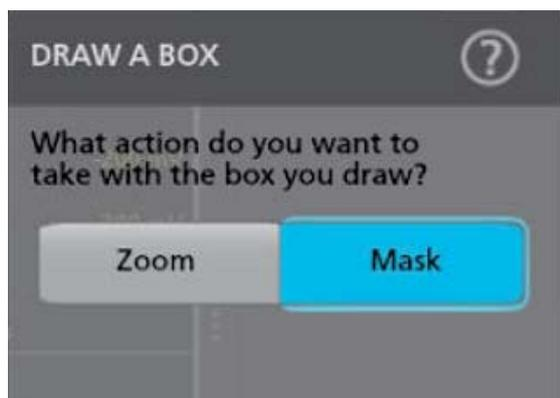
2. 点击菜单外部以关闭 **画框** 菜单。画框图标将突出显示，表示它处于“模板”绘制模式。
