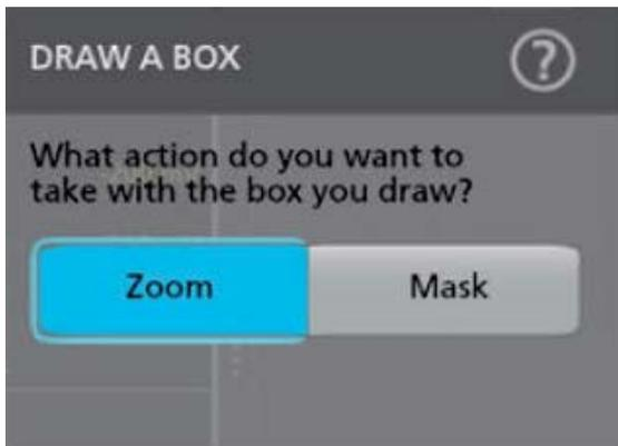
点击**结果栏**右上角的“画框”**画框缩放图标**按钮，然后在“波形”视图中触摸并拖动，以便在所需区域上绘制一个框。“缩放”模式保持启用状态，以便您在“缩放概览”的不同区域绘制框以缩放，或在同一区域绘制框以进一步放大。
