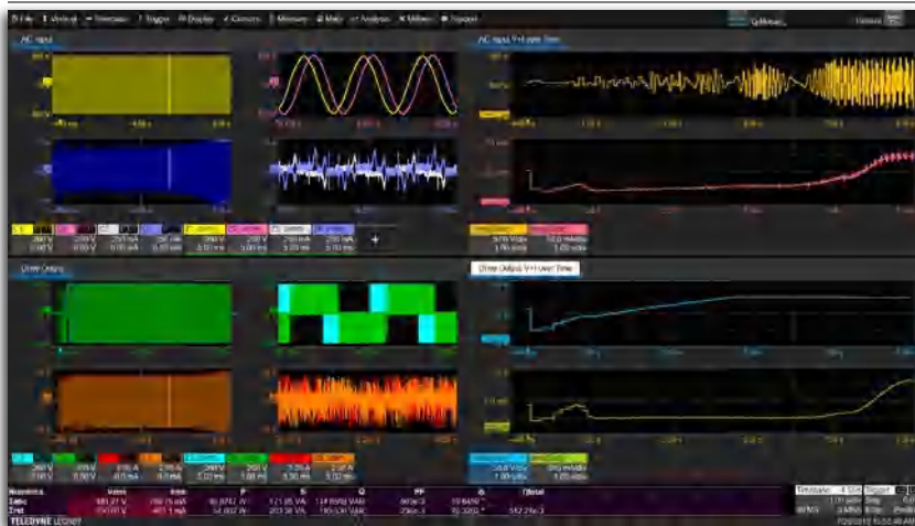
采集电压、电流和其他信号，并使用每周期波形计算动态响应，以更好地了解复杂的驱动、控制和电机行为
