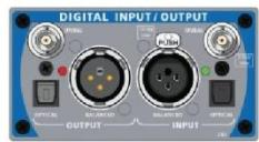
**AES/SPDIF** B 系列 APx DIO 选件在 XLR 上设有 AES3、AES/EBU 平衡数字 I/O 端口、BNC 上设有不平衡的 SPDIF 数字 I/O 端口，以及 TOSLINK 光学数字 I/O 端口。
