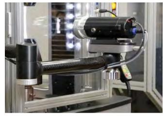
毎组Advantage系列视频引伸计的测量镜头都配置有可溯源的校准模块,可用于针对各类型测试要求实现快速校准。 这些校准模块具有ISO 17025可溯源校准报告。
