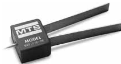
标准配置包括了设备包装箱、位移规、两个可用的硬质刀口以及说明书。
