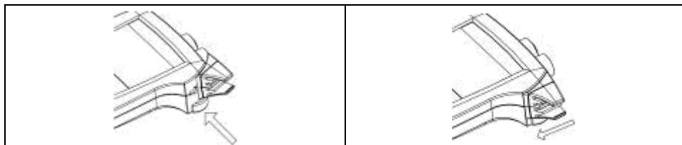
电极夹是一个电极的固定装置，可以安装在仪表外壳左右任意一侧。方便左右开弓，左手都可进行仪表操作。
