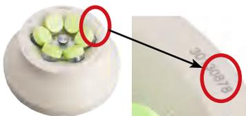
4. 盖上机盖：打开电源开关，轻轻向下按压机盖，听到机械咔嗒声，同时显示屏上将显示 Close 图案（如下图所示）。
