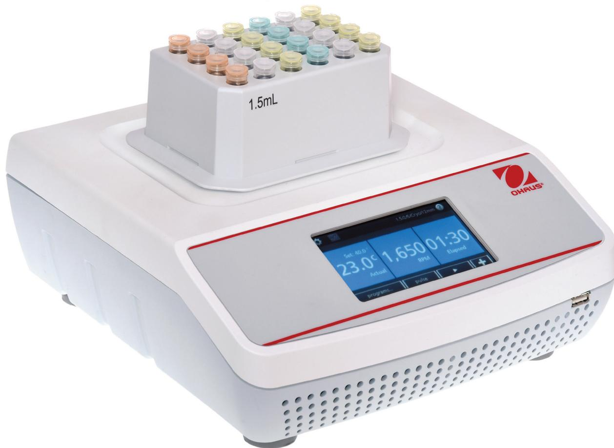
恒温混匀器适用于温度（低于100° C）控制精确、摇荡速度高且均匀一致的实验。混匀器具有加热和摇荡功能，使用可换模块适配多种试管和微孔板。用户通过清晰直观的LCD触摸屏可保存或终止实验，设备可存储5个用户设置的处理程序，每个程序最多5步。更先进的电子设计，可在不同操作条件下提供可靠的温度控制。
