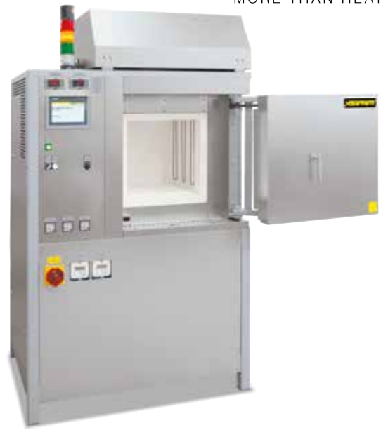
高温炉 HT 64/17 DB100-2 配备用于脱离操作的安全包
