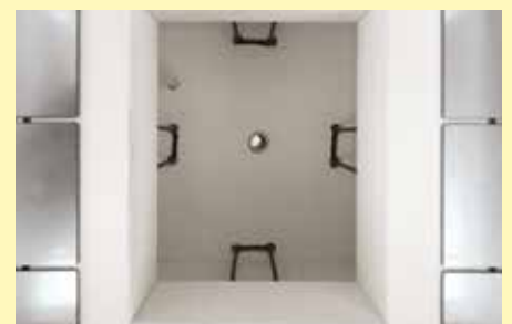
LHT 01/17 LB Speed型号采用4面加热的炉膛
