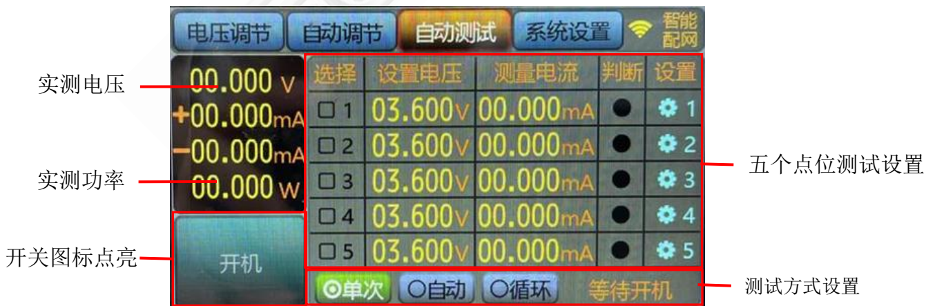
图5.6.2 电池充放电自动测试
