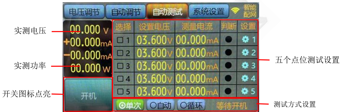
图5.6.1 电池充放电自动测试
