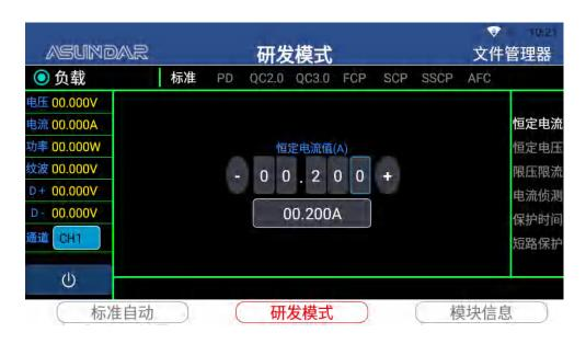
PD负载:选择"PD",可识别并触发产品的PD2.0及PD3.0协议。
