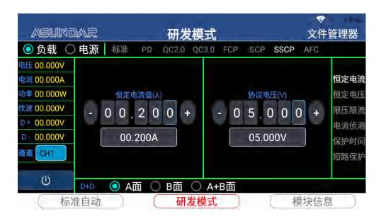
AFC负载:选择"AFC",可识别并触发产品的AFC协议。
