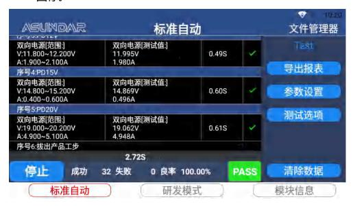
最终测试结果可在标准自动主界面点击"导出报表"按钮,选择将相应测试数据以报表形式导出到存储设备,以便在PC端查看。
