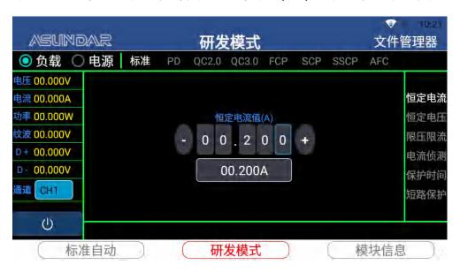
恒定电压:选择"恒定电压",即负载的"恒压(CV)"方式,可设定负载电压。根据产品输出电压和负载所设定恒压电压的差值及传输内阻决定负载电流及功率。
