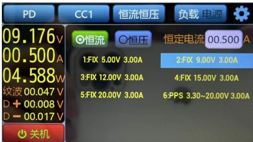
当负载没有识别到PD协议，需切换对应的CC线,如果还无法识别，请更换带有CC线功能或是完好的TYPE-C线，如下图：4.2.4.2所示，可点击屏幕相应图标直接进行选择控制，可利用调节旋钮快速微调测试参数。
