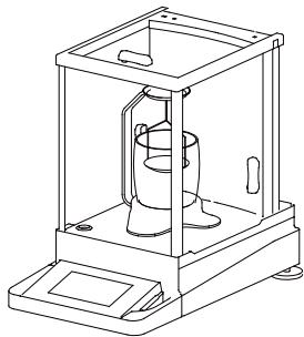
6) 然后将测试架安装在 C 型支架上，到此密度测量装置已经安装完毕。
