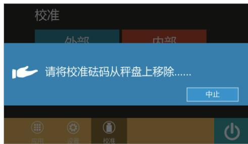
► 根据提示将校准砝码从秤盘上移除。
