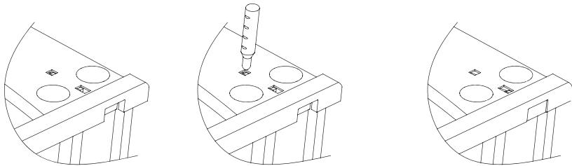
本系列天平玻璃风罩具有锁定功能。从附件中取出解锁笔，根据示意图点击黄色解锁模块，当黄色模块与天平侧面相平时，玻璃门方可打开。
