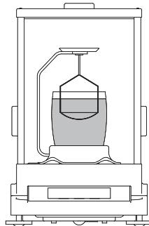
▶ 将测试架放到密度称量工具的框架内。
