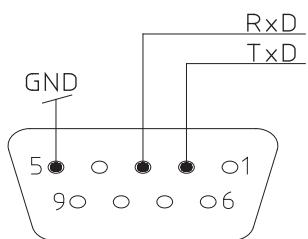
每台天平都可以通过 RS-232C 接口与外围设备连接（例如：RS-232C 串口打印机或具有 9 针插头的微机）。将天平与打印机连接起来，按照打印机的参数设置后即可选择 输出称量结果。
