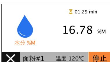
▷ 当使用定时关闭模式时，水分仪在到达您设定的时间后停止测定分析，并转到水分测定完成界面。
