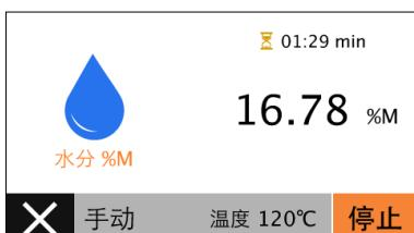
▷ 当使用手动模式时，按右下角“停止”键，水分测定终止，并转到水分测定完成界面。
