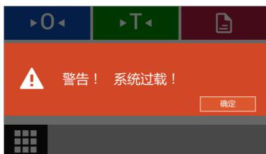
水分仪内部检测到加载物体超过最大量程：
