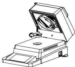
► 放入样品盘支架安装芯，放置锁扣，并旋转到位。
