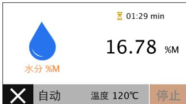
▷ 当使用自动或损失量关闭模式时，水分仪将会自动停止水分测定并转到水分测定完成界面。
