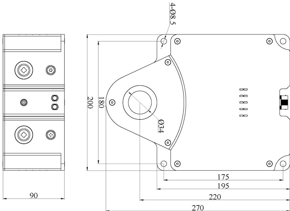
4.2.5 低压小电流传感器尺寸 (单位 mm)
