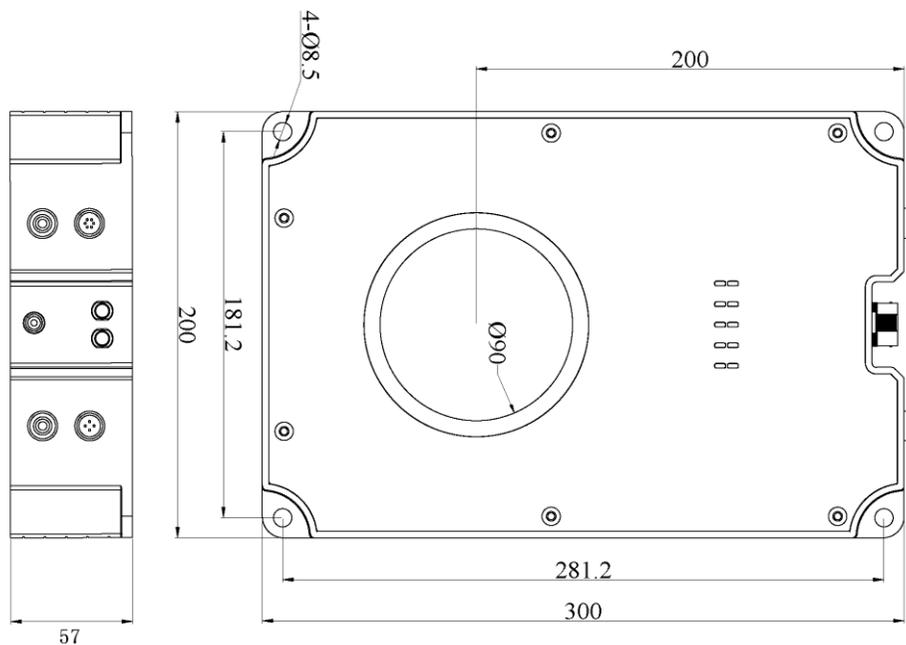
4.2.3 大电流机箱式传感器尺寸 (单位 mm)
