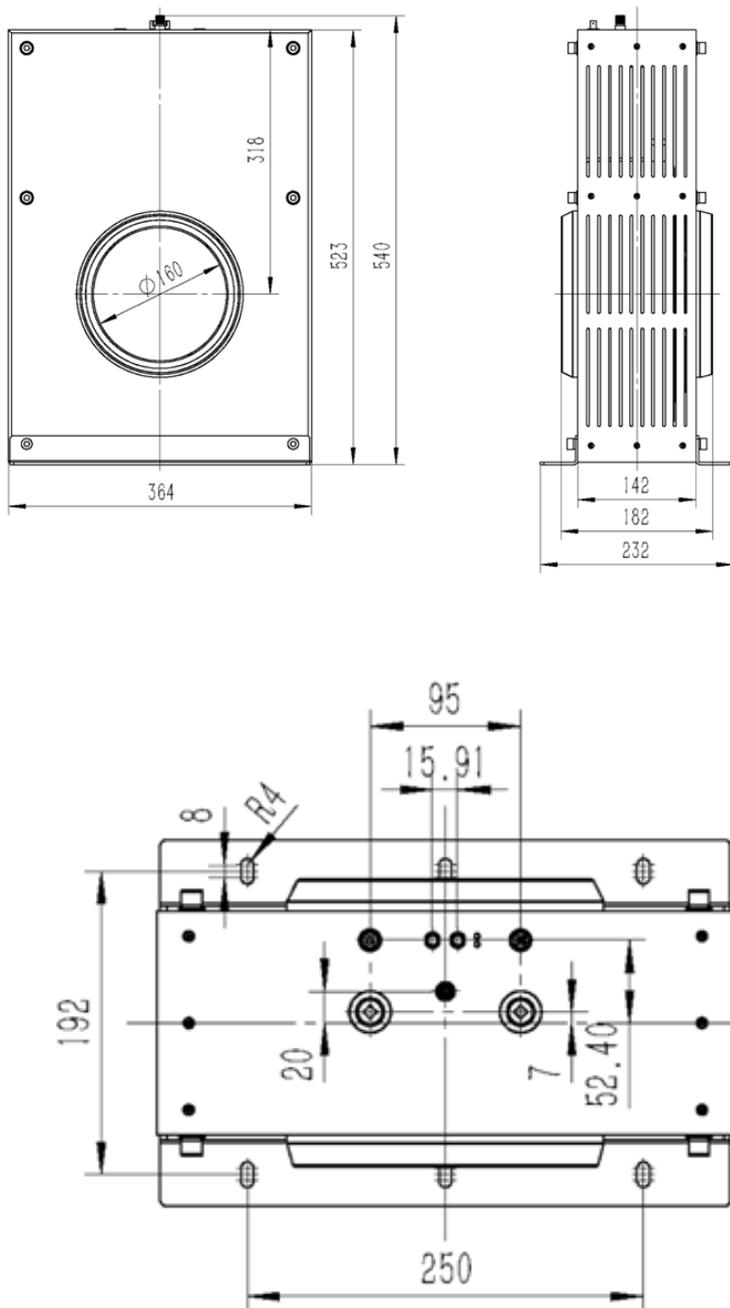
4.2.4 高压小电流传感器尺寸 (单位 mm)
